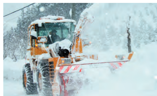
道幅ぎりぎりまで除雪作業する除雪隊員
