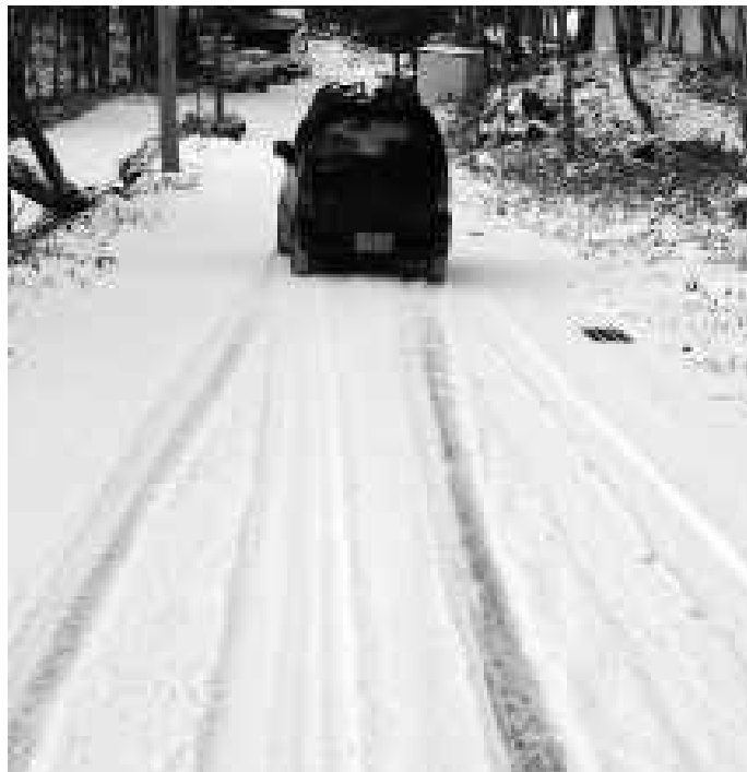
安全な場所でブレーキテスト（テスト車はABS無）
